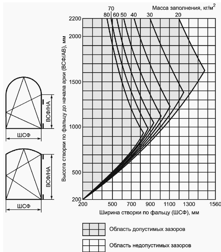
Массу наполнения рассчитывают с учетом массы стекла толщиной 1 мм и принимают равной 2,5 кг/м<sup>2</sup>.
