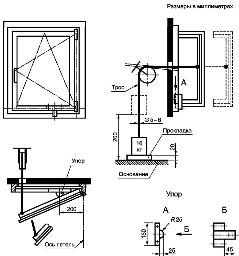
Примечание. Падение груза прекращают на расстоянии 20 мм от основания (например, с помощью прокладки). Длину троса определяют из условия одновременного касания грузом основания и створкой упора.
