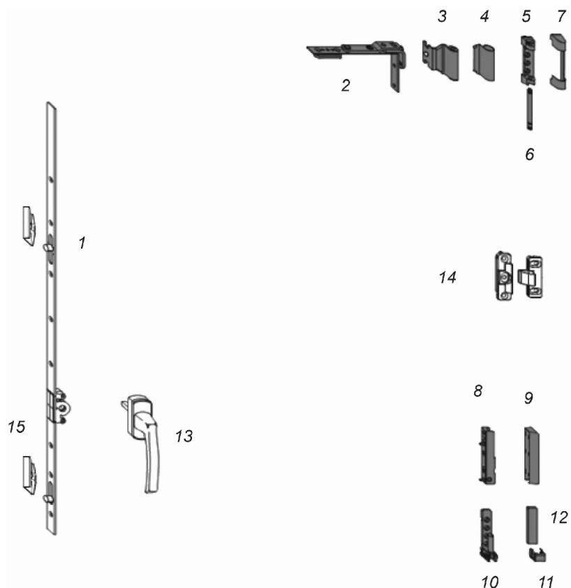
1 - запорный механизм; 2 - поворотная петля; 3 - петля-уголок; 4 - декоративный колпачок петли-уголка; 5 - верхняя петля на коробке; 6 - штифт; 7 - декоративный колпачок верхней петли на коробке; 8 - нижняя петля на створке; 9 - декоративный колпачок нижней петли на створке; 10 - нижняя петля на коробке; 11 - короткий декоративный колпачок нижней петли на коробке; 12 - длинный декоративный колпачок нижней петли на коробке; 13 - оконная ручка; 14 - средний прижим; 15 - запорная планка
