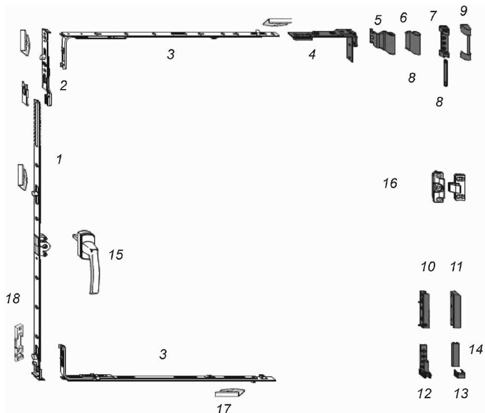
1 - поворотный механизм; 2 - концевой запор;
