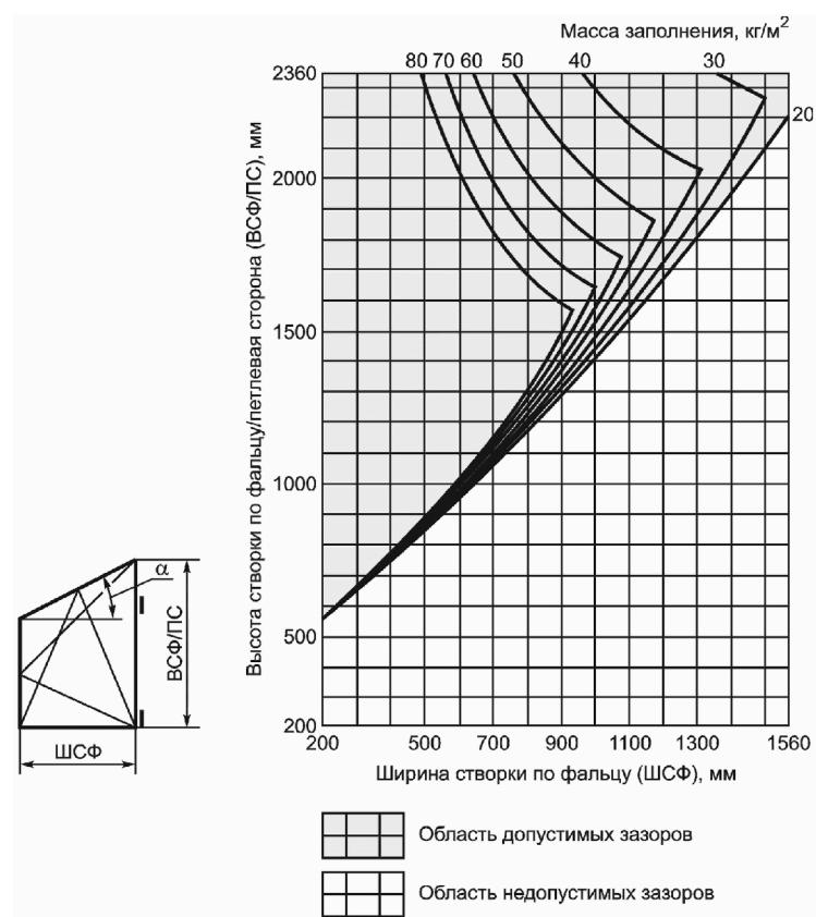
Массу наполнения рассчитывают с учетом массы стекла толщиной 1 мм и принимают равной 2,5 кг/м<sup>2</sup>.
