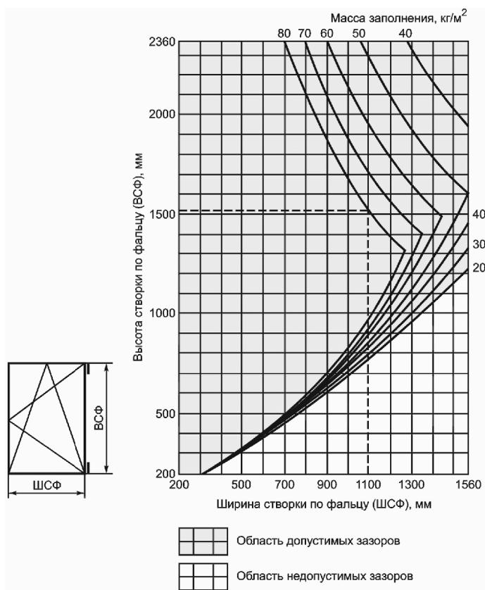
Массу наполнения рассчитывают с учетом массы стекла толщиной 1 мм и принимают равной 2,5 кг/м<sup>2</sup>.
