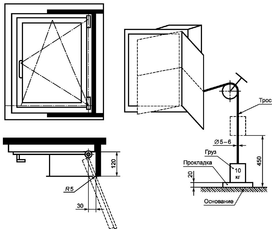
Примечание. Падение груза прекращают на расстоянии 20 мм от основания (например, с помощью прокладки). Длину троса определяют из условия одновременного касания грузом основания и створкой упора.
