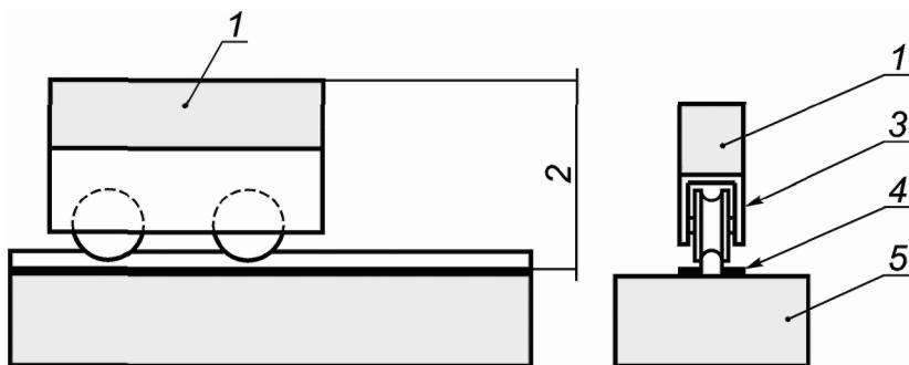
1 - равномерная нагрузка; 2 - прогиб (не более 2 мм после испытаний на безотказность п. 5.4); 3 - роллер;
